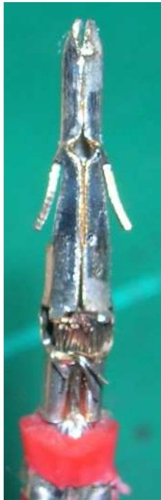
Diese Haken müssen eingedrückt werden um die Kontakte aus dem Stecker zu lösen.
